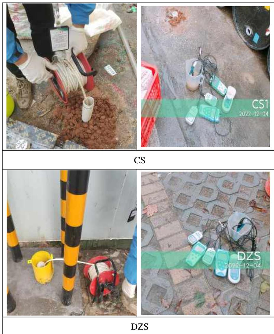
图 7.2-2 现场地下水建井、采集地下水样品照片
