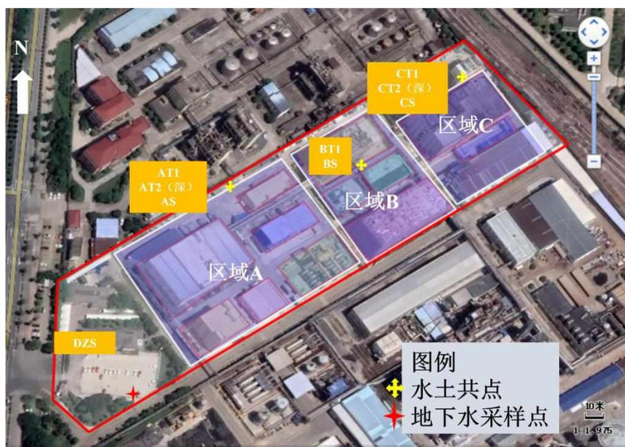
图 6.1-1 重点单元土壤地下水监测点位
